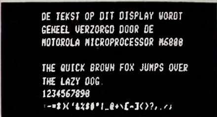
Afb. 28. De microcomputer dwingt de oscilloscoopstraal tot het schrijven van een complete karakterset volgens de opbouw van fig. 21.
